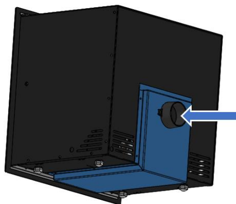
Figura nº4 - Acessório para canalizar a entrada de ar pela parte traseira
