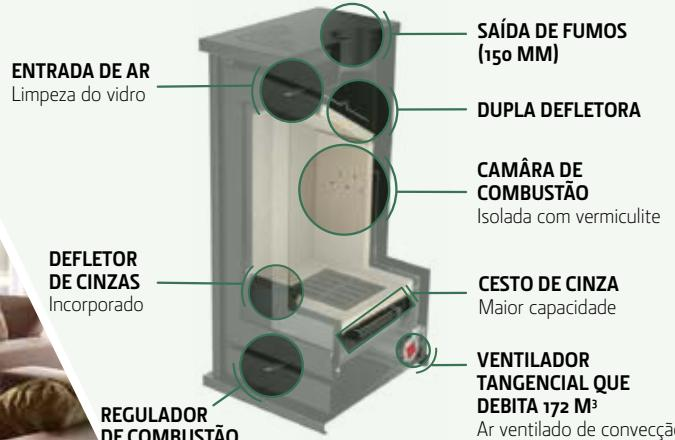
Todas as salamandras a lenha para aquecimento local possuem um defletor para direcionar as cinzas para a gaveta, de forma a facilitar a limpeza do seu equipamento. Apresentam dupla defletora: uma em chapa e outra em vermiculite, tornando os equipamentos mais eficientes. A circulação de ar no seu interior, contribui para que o vidro esteja sempre limpo durante o seu funcionamento.
