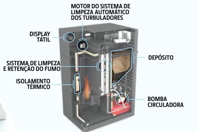
As caldeiras SZM A apresentam um sistema automático de limpeza dos turbuladores e do queimador. É possível adquirir um silo opcional, que aumenta a capacidade da sua caldeira em 200 kg. Este silo possui um sensor de nível de pellets que deteta quando o depósito está a ficar vazio, gerando um alerta para proceder ao reabastecimento. Esta gama incorpora um kit hidráulico completo e um cabo de ligação ao depósito de inércia.
