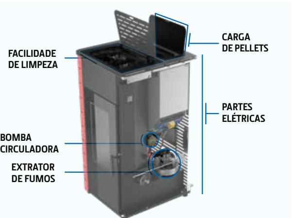
Esta gama apresenta um duplo sistema de limpeza - auto-cleaning do queimador e limpeza manual do circuito de fumos. A eletrónica e as partes elétricas estão completamente separadas das partes hidráulicas, para melhor robustez e fiabilidade. Para além da nova câmara de combustão mais estanque, que permite um aumento da eficiência da combustão, apresenta ainda uma boa performance termodinâmica com utilização de temperaturas superiores na queima.
