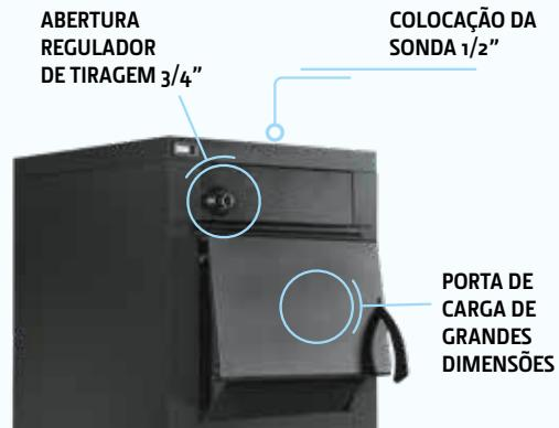
Esta gama permite incorporar um sistema de ventilação para controlo automático da entrada de ar para a combustão em função da temperatura da água e controlar o funcionamento da bomba circuladora. Possui um sistema hidráulico com conexões de 1''1/4 e dispõe de um circuito adicional para instalação de uma válvula de descarga térmica, aumentando assim a segurança da instalação. O equipamento permite ainda um fácil acendimento e limpeza.
