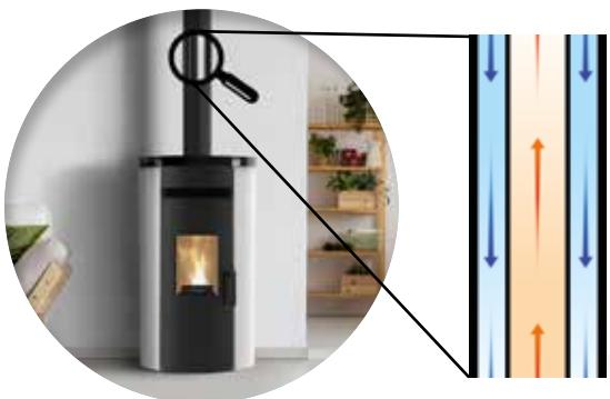
Caso prefira, pode colocar um tubo concentríco que permite que a entrada do ar e a saída dos gases ocorra num só tubo. O equipamento irá aspirar o ar para a combustão exterior através do tubo instalado na parede exterior e irá expelir os gases da combustão para o exterior através da parede interior, conforme representado na figura.
