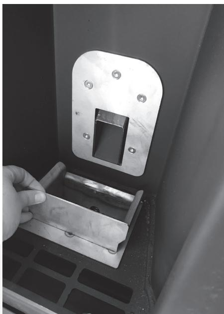
Com um aspirador de cinzas, remover a cinza acumulada dentro da câmara e dentro do porta-braseiro.
