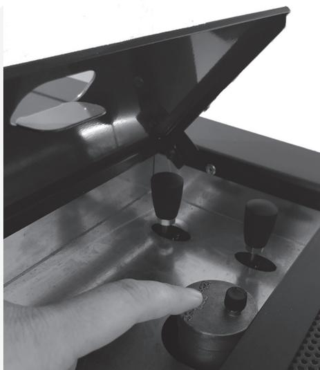
Além do fator que tem em conta em cada vez que se torna um purgado da estufa e da instalação, fique com uma revisão da pressão que temos, já que a pressão está por baixo de 600mbar, quando a estufa se ponga em funcionamento va um erro de baixa pressão.
