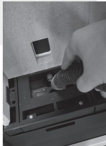
Com um aspirador de cinzas, remover a cinza acumulada dentro da câmara e dentro do porta-braseiro.
