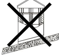
(1) No caso de condutas de fumos colocadas uma ao lado da outra, uma delas deverá ultrapassar a outra no mínimo em 50 cm, para evitar passagens de pressão entre os próprios cabos
