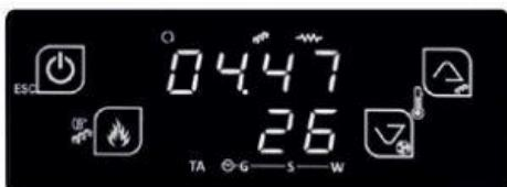
Funcionalidades: acendimento automático, função cronotermostato com possibilidade de programação diária, semanal e de fim de semana, arranque automático à hora programada e regulação automática da temperatura desejada, modulação automática (potência 1 a 6 e auto), ajusta a potência do queimador às necessidades de aquecimento e de acordo com a temperatura desejada, visualização de todos os parâmetros do recuperador.
